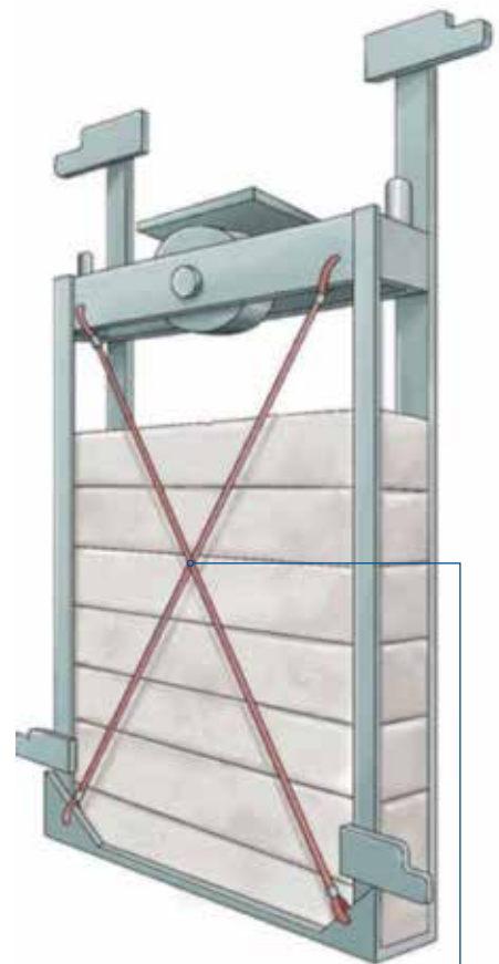
EJEMPLO DE PROTECCIÓN DE CAÍDA DEL CONTRAPESO
