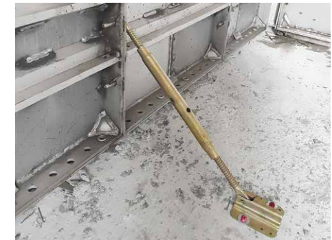
Bracket AL Tensor Asegura el posicionamiento preciso de los paneles de muro, y previene el giro del encofrado
