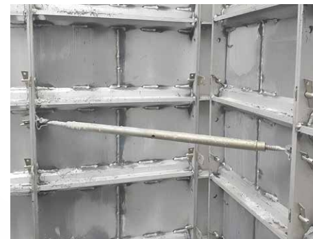
Bracket Tensor Esquinero Asegura un ángulo de 90° en todas las esquinas
