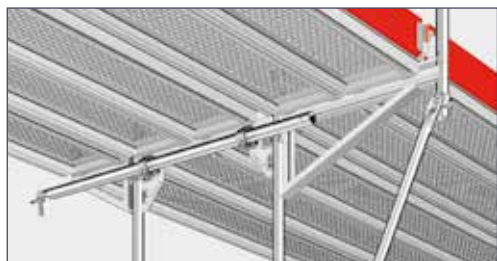
Tubo de anclaje con dos grapas para anclar el marco.
