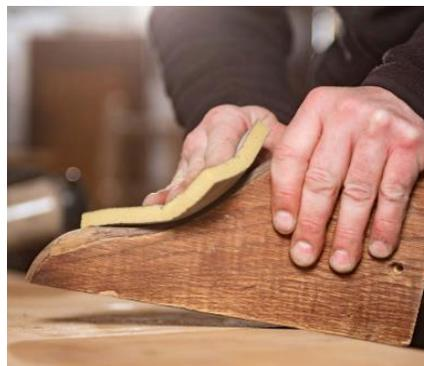
Revestimiento de lija por ambos lados con suave espuma en el interior, que distribuye la presión del carburo de silicio, ideal para procesos de curvas, bordes, depresiones, radios y superficies.
