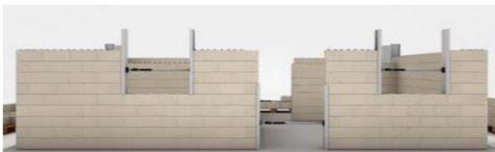
8.-siguiendo el mismo procedimiento de montaje y tomando en cuenta ventanas y puertas al llegar a la altura de 2,6 m de altura se procede a la colocación de las piezas especiales para crear pendientes
