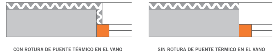
↑ Figura 18.19 Casos del detalle de instalación de la aislación en la ventana
