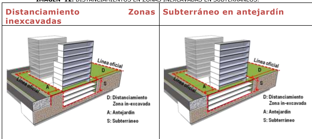
IMAGEN 12: DISTANCIAMIENTOS EN ZONAS INEXCAVADAS EN SUBTERRÁNEOS.
